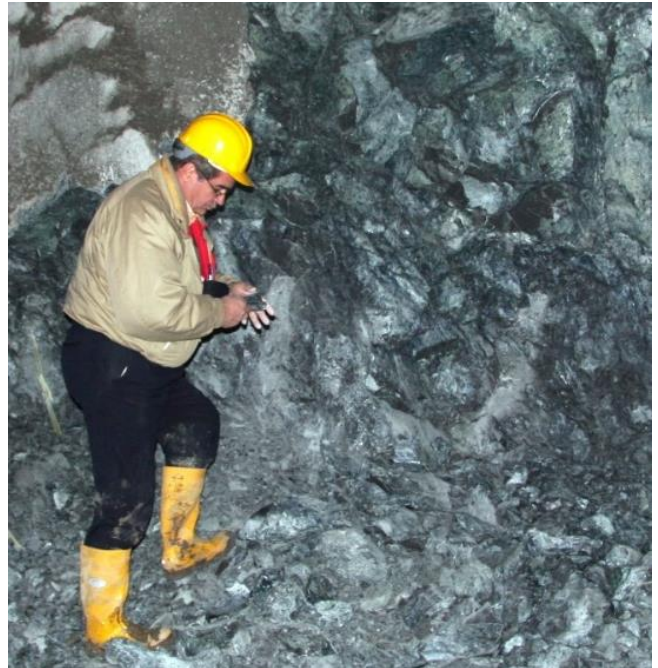
Εικόνα 106. Ο Παύλος Γ. Μαρίνος στο πεδίο, ταξινομώντας τη βραχώμαζα σε μέτωπο εκσκαφής σήραγγας της Εγνατίας Οδού.
