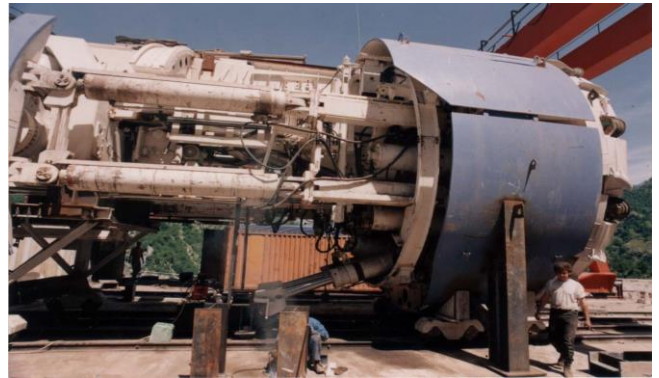
Εικόνα 66. Γενική εικόνα του μπροστινού τμήματος της βραχομηχανής TBM που χρησιμοποιήθηκε στην διάνοιξη της σήραγγας προσαγωγής με την χαρακτηριστική κυρία δοκό και την ψευδο-ασπίδα στην και αμέσως μετά την κοπτική κεφαλή.
