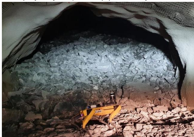
Εικόνα 83. Τετράποδη ρομποτική πλατφόρμα κατά τη διερεύνηση δυσπρόσιτης περιοχής στο υπόγειο μεταλλείο Kiruna, Σουηδία ( Boston Dynamics ).
