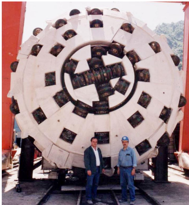
Εικόνα 65. Εικόνα της κοπτικής κεφαλής με την ψευδοασπίδα της βραχομηχανής TBM της σήραγγας προσαγωγής Μεσοχώρας με την διάταξη των κοπήρων-δίσκων.
