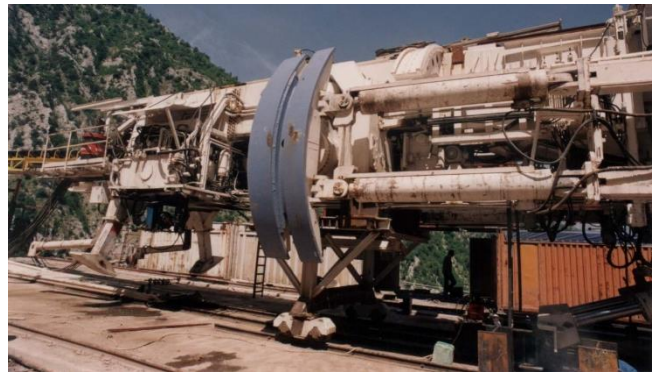
Εικόνα 67. Γενική εικόνα του πίσω τμήματος της βραχομηχανής TBM που χρησιμοποιήθηκε στην διάνοιξη της σήραγγας προσαγωγής με την χαρακτηριστική κυρία δοκό και τα πλευρικά πέδιλα στήριξης στις παρειές της εκσκαφής της σήραγγας.
