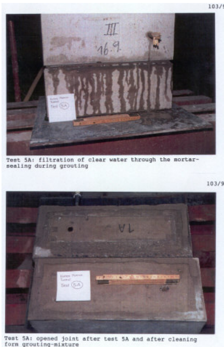
Εικόνα 9: Διήθηση καθαρού νερού δια μέσου της κονιάς στεγάνωσης.
