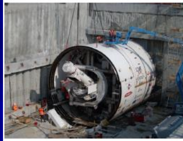
Ασπίδα εδαφικής εξισορροπητικής πίεσης (EPBS LOVAT (RME-370SE)
